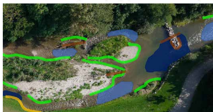
Das Bild zeigt eine lokale Aufweitung mit Steinbuhne am Michelbach in Böheimkirchen.
