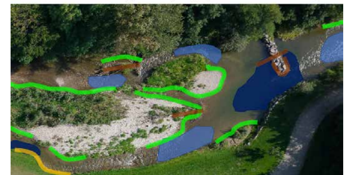
Das Bild zeigt eine lokale Aufweitung mit Steinbühne am Michelbach in Böheimkirchen.
